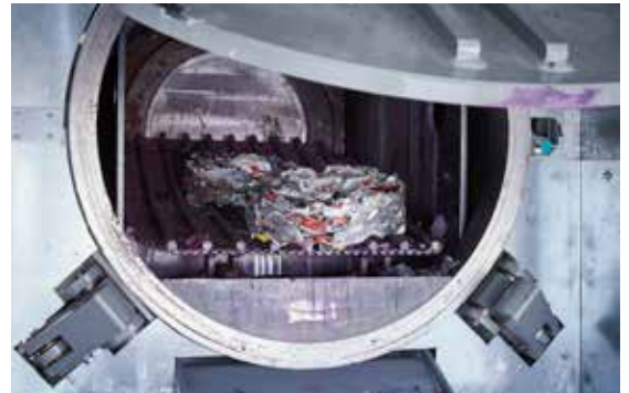
Die von Fremdstoffen befreiten Spraydosen werden bei 300 Bar unter inerten Bedingungen gepresst
